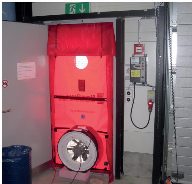
Bild E6: Eingebautes Blower-Door-Gerät.
